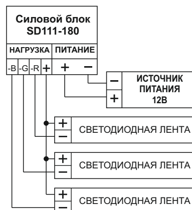
Схема подключения (одноцветная лента)
