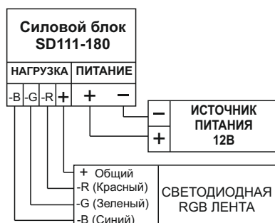
Схема подключения (RGB лента)
